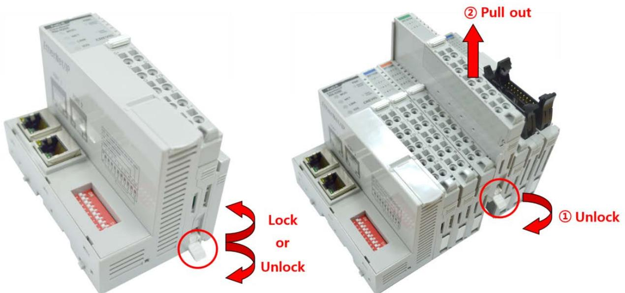
Как показано на рисунке выше (слева), для фиксации модуля серии G его следует закрепить на DIN-рейке фиксирующими защёлками. Для этого откиньте верхнюю часть фиксирующей защёлки.
