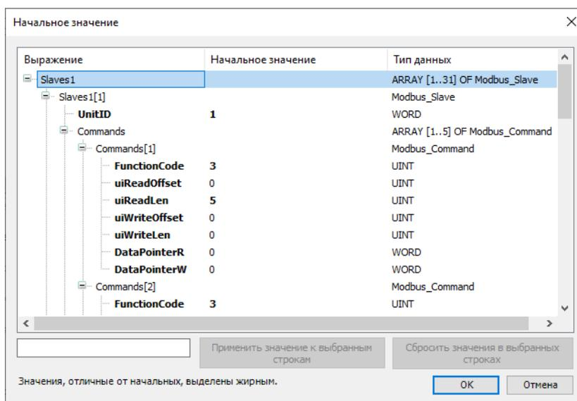
**Примечание.** Данный функциональный блок при обнаружении потери связи с Modbus устройством (например, три последовательных ошибки передачи, уставка количества ошибок является входным параметром ФБ) отключает данное устройство от общего обмена на определённое количество циклов опроса (данное количество является входным параметром ФБ).
